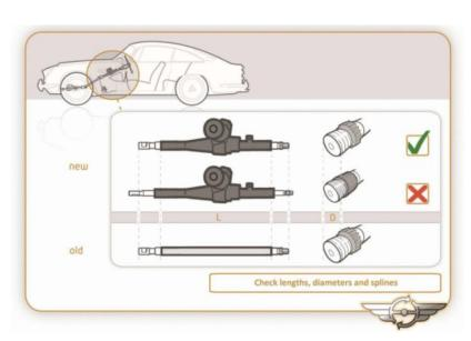
In der Automobilindustrie ist es üblich, dass bei den Keilwellenverbindungen geringe Toleranzen auftreten. In Ausnahmefällen kann das Einsetzen einer neuen Welle von der EZ-Einheit in die originale (alte) Kardanwelle einen festen Sitz verursachen. Dies ist manchmal relativ einfach zu beheben, indem man nur ca. 0,2 mm (0,007 Zoll) im inneren Teil des Kreuzgelenks und damit auch der Verzahnung auf der Abtriebswelle an der EZ-Einheit abschleift
