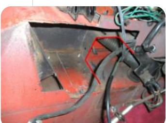
Schritt 13. (XK150 Frischluftheizung LHD Um genügend Platz für den Elektromotor der EZ-unit zu schaffen, muss ein Teil des Blechs unter dem Armaturenbrett entfernt werden. Markieren Sie den zu entfernenden Bereich gemäß der Abbildung links und schneiden Sie ihn aus. Achten Sie darauf, dass Sie keine Kabel oder Rohre beschädigen. Markieren Sie dann den vertikalen Teil gemäß dem Beispielbild links und schneiden Sie auch diesen Teil aus.
