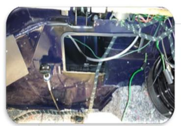
Schritt 15. (XK150 reguläre Zentralheizung LHD) Schneiden Sie weg, was notwendig ist, damit die EZ-Einheit passt. Ein Beispiel finden Sie auf dem Foto. Der Elektromotor muss nach rechts zeigen.
