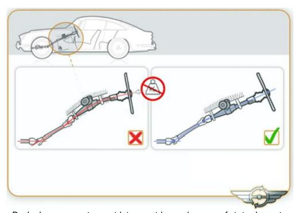
Das Lenksystem muss immer richtig ausgerichtet und spannungsfrei eingebaut sein.
