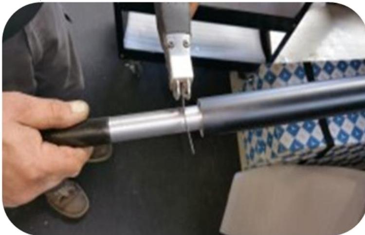
Danach kann die ursprüngliche Lenkachse auf die richtige Größe zugeschnitten werden. Verwenden Sie wiederum die F7-Einheit um diese Größe zu
