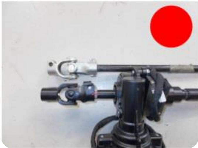
Wenn das Gusseisen-U-Joint verwendet wird, ist darauf zu achten, dass die roten Markierungen übereinstimmen, d.h. die Markierungen auf dem U-Joint müssen mit denen auf der EZ-Einheit übereinstimmen.
